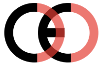
Falsche CE-Kennzeichnung (zu dicht)
