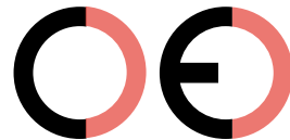
Falsche CE-Kennzeichnung (zu großer Zwischenraum)
